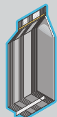
Klotzbodenbeutel mit Vierseiten-Siegelung, ZIP und versetzter Längsnaht block bottom bag with off set 4 vertical seals and cross web zip
