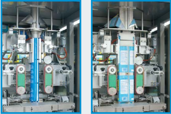
Particolare di due tubi conformatori. Particular of two conformatori tubes.
